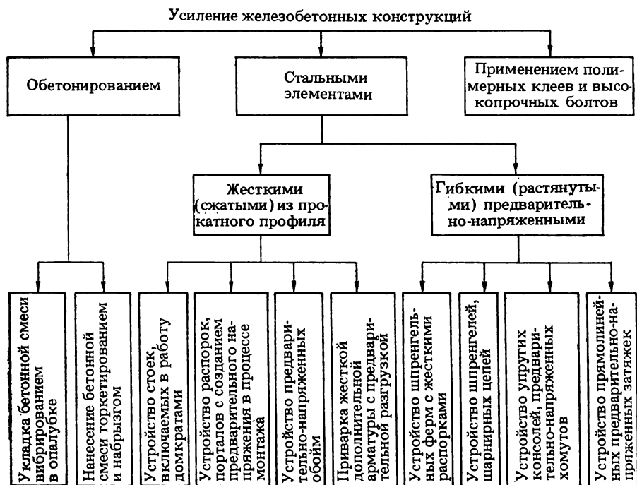
Схема 2. Классификация способов усиления железобетонных конструкций.
